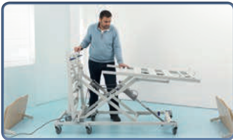
Przykręcenie dolnej części stelaża łóżka w pozycji poziomej.
