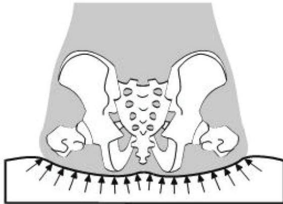
Para obter uma adequada distribuição das pressões, a almofada dispõe de um sistema de flutuação que aumenta a superfície de contacto com o utilizador. Desta forma, obtém-se uma redução da pressão por unidade de superfície, evitando assim a compressão prolongada dos vasos sanguíneos situados ao redor das proeminências ósseas e permitindo uma melhor irrigação sanguínea dos tecidos.
